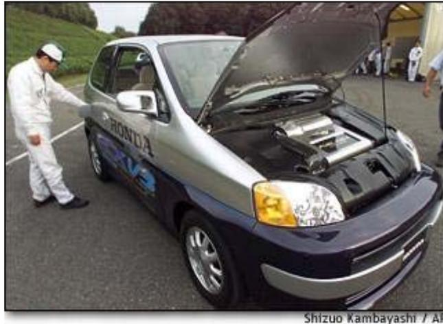
**Figure 1.7.** *Le prototype Honda FCX-V3 équipé d'un réservoir d'hydrogène sous pression*
